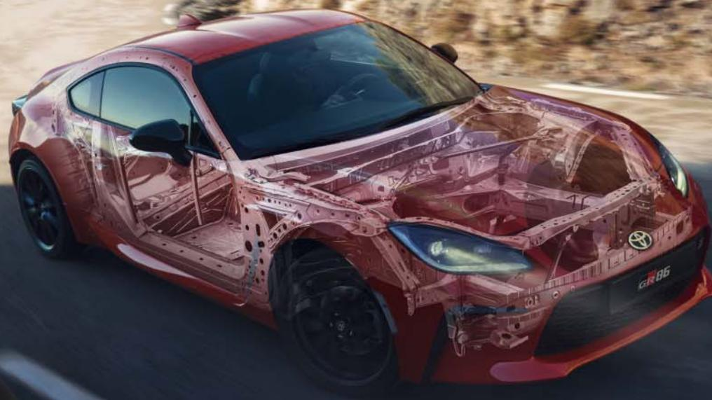
La GR86 dispose d'une structure de carrosserie très rigide. Des matériaux robustes entourant l'habitacle et une couche absorbant les chocs dans le toit intérieur protègent les passagers en cas de collision. La structure extérieure de la carrosserie absorbe et répartit efficacement l'énergie de l'impact.
