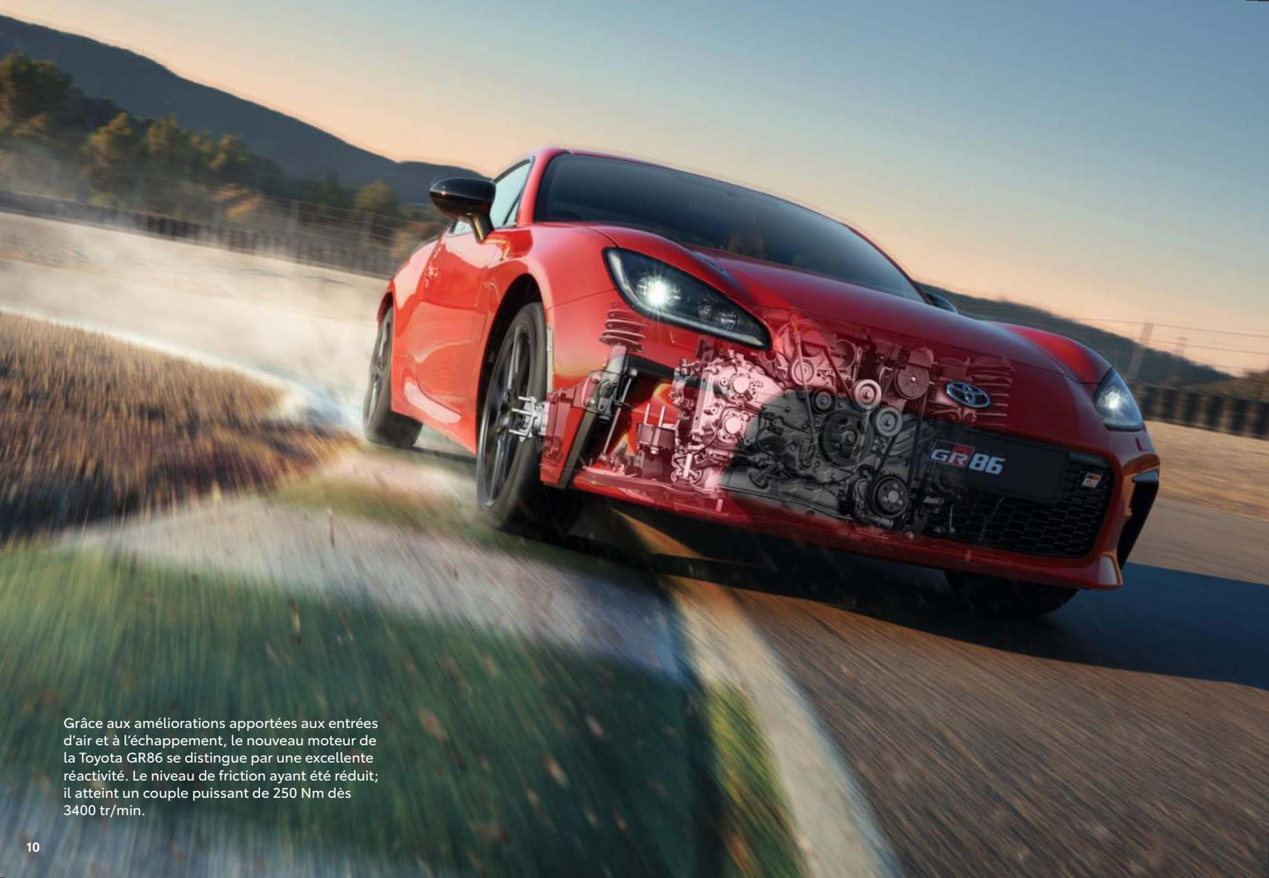
Grâce aux améliorations apportées aux entrées d'air et à l'échappement, le nouveau moteur de la Toyota GR86 se distingue par une excellente réactivité. Le niveau de friction ayant été réduit; il atteint un couple puissant de 250 Nm dès 3400 tr/min.
