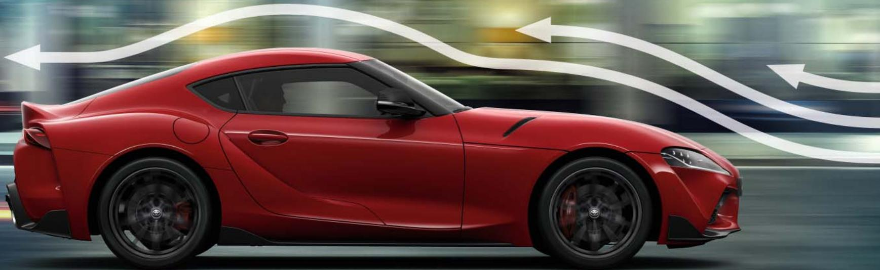
Die hochsteife aerodynamische Karosserie verbessert durch ihre Stabilität den Fahrkomfort, das Double-Bubble-Dach optimiert den Luftwiderstand, und ein gewölbter Heckspoiler sorgt für mehr Anpressdruck.
