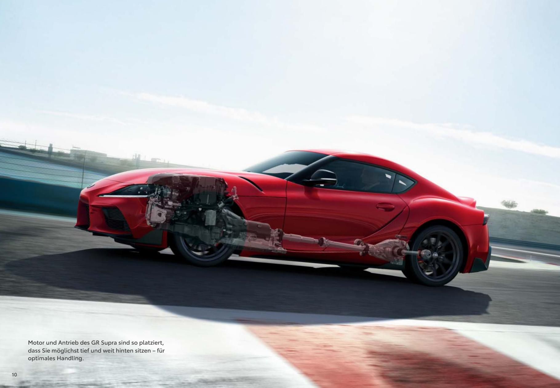
Motor und Antrieb des GR Supra sind so platziert, dass Sie möglichst tief und weit hinten sitzen – für optimales Handling.
