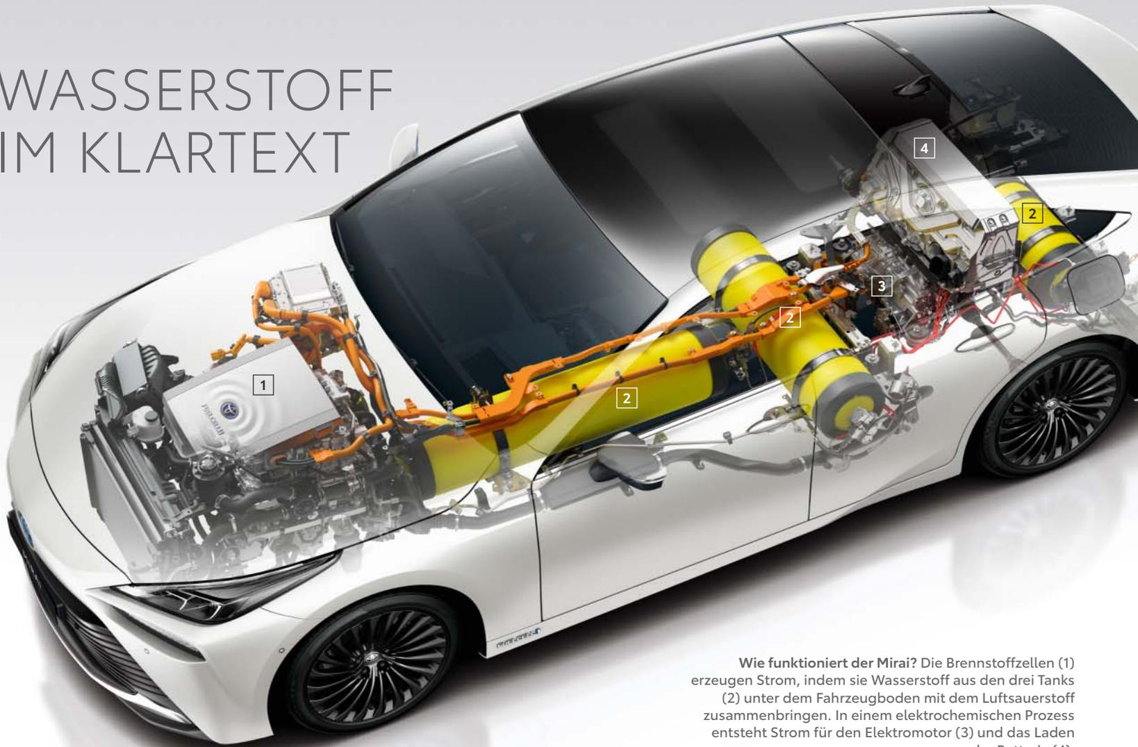
Wie funktioniert der Mirai? Die Brennstoffzellen (1) erzeugen Strom, indem sie Wasserstoff aus den drei Tanks (2) unter dem Fahrzeugboden mit dem Luftsauerstoff zusammenbringen. In einem elektrochemischen Prozess entsteht Strom für den Elektromotor (3) und das Laden der Batterie (4).
