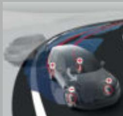
Per evitare di uscire dalla traiettoria nelle curve su fondo scivoloso, **il controllo della stabilità (VSC)** attiva automaticamente i singoli freni e, se occorre, riduce la potenza del motore.
