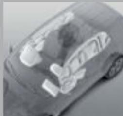
**Sette airbag SRS** – inclusi airbag per conducente e passeggero anteriore nonché l'airbag per le ginocchia del conducente completano il sistema di ritenuta.
