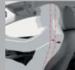
*Le système de protection traumatique du dossier et de l'appui-tête des sièges avant (WIL) atténue les conséquences d'une collision à basse vitesse, surtout par l'arrière.*
